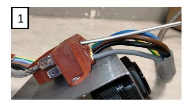
**2** / Lever ensuite le tournevis pour permettre l'abaissement de la mâchoire à ressort du contact du bornier.
