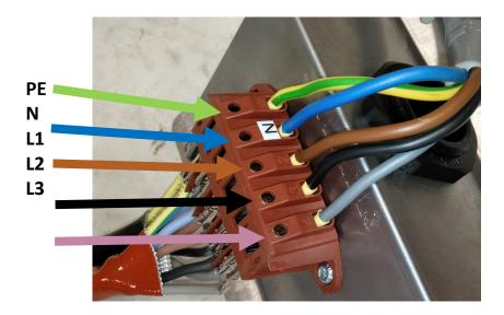
Le raccordement de l'alimentation secteur se fait à l'arrière du générateur. Il est souhaitable que les 5 conducteurs soient équipés d'embouts de câblage à leurs extrémités.
